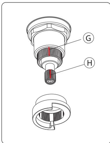
Термостатический клапан настраивается на заводе и тестируется при температуре 38°C, обозначенной красной меткой (H) на шпинделе, совпадающей с прямой черной линией (G) на корпусе термостатического картриджа в положении «двенадцать часов».
