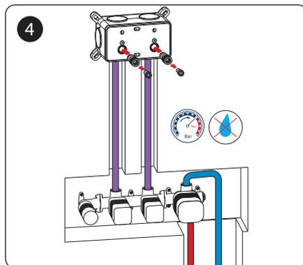
Снимите крышку с блока верхнего душа. Установите соединительные трубки и пробки для проверки давления. Откройте систему подачи воды и проверьте соединения на герметичность. После завершения тестирования извлеките пробки и соединительные трубки. Установите крышку на место.
