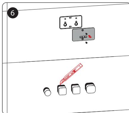
Снимите крышку со встроенного блока верхнего душа. Следуя линии разреза на коробке, отрежьте выступающую часть коробки.
