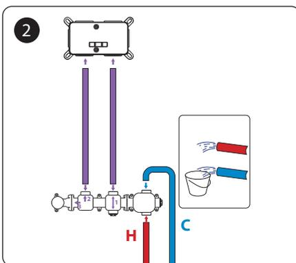
Подсоедините корпус встроенного блока к водопроводу, используя соответствующие фитинги, (С) – входное отверстие для холодной воды, а (Н) – входное отверстие для горячей воды.
