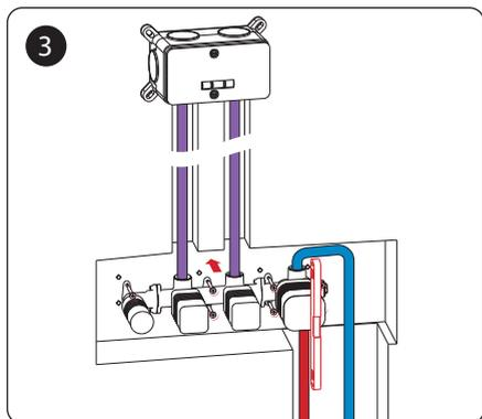
Используя уровень, установите встроенный блок душевой системы на стене и отметьте положение крепежных выступов (x6). Просверлите отверстия и закрепите встроенный блок на стене с помощью винтов. Установите на стене встроенный блок тропического душа и закрепите его с помощью винтов.
