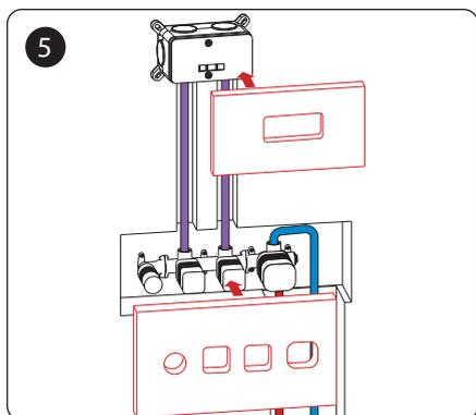
Используя шаблон, вырежьте отверстие в плитке, затем соответствующим образом уложите плитку. Не снимайте защитные крышки до завершения всех отделочных работ. Это защитит блок управления и блок верхнего душа от попадания пыли.
