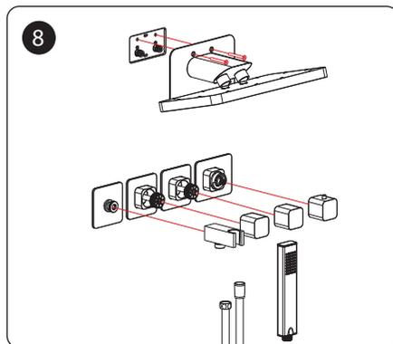
После укладки облицовки нанесите водостойкий герметик на край плитки. Накрутите декоративные гильзы на картридж термостата и диверторы и аккуратно наденьте на них декоративные накладки в соответствии с символами на лицевой стороне накладки и прижмите к стене. Установите соединительные трубки в блок верхнего душа.
